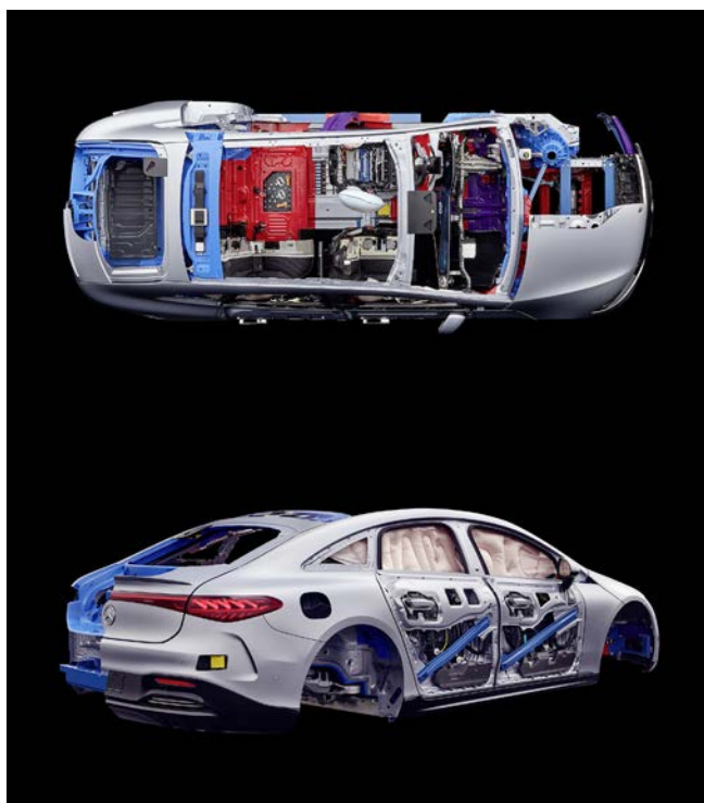
AL DESNUDO | Así son las estructuras de seguridad que protegen la integridad de los ocupantes en el habitáculo.
